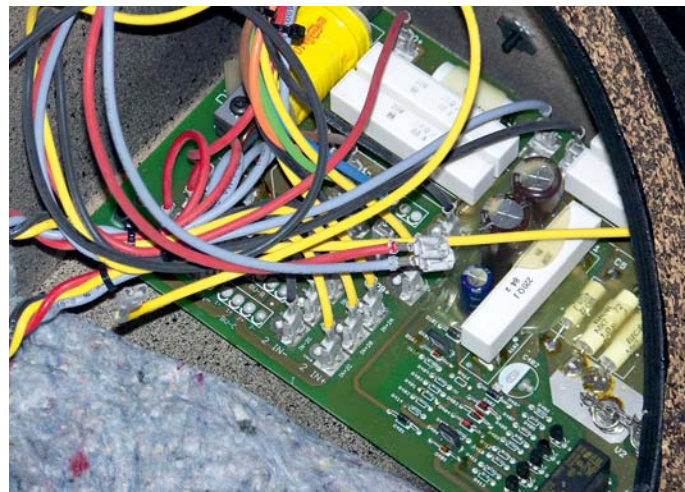
Z prawej strony we wnętrzu obudowy znajduje się dość mocno rozbudowana płytka układu elektronicznego, która – oprócz pasywnej zwrotnicy – zawiera układ zabezpieczenia drivera, opracowany przez firmę Dynacord.
